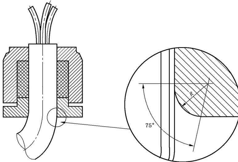
图 A.2 可弯曲电缆进线口圆角
